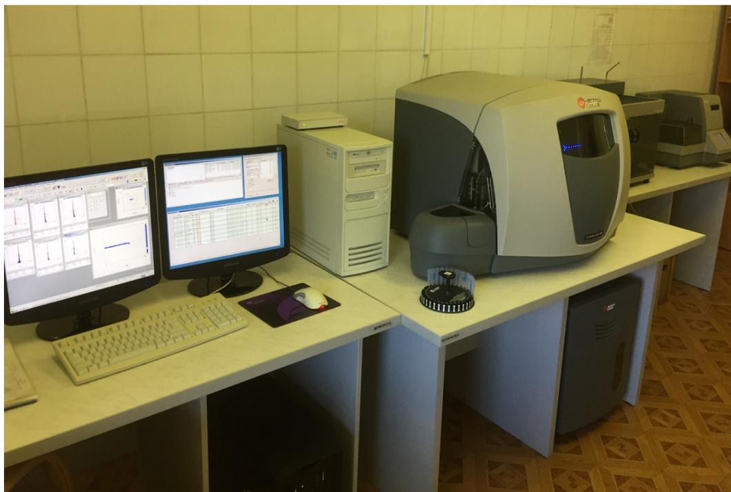
Рисунок 9 – Система проточной цитометрии Cytomics FC 500 дает возможность проводить как рутинные гематологические исследования, так и сложные исследования субпопуляций лимфоцитов. Имеет программное обеспечение СХР.
