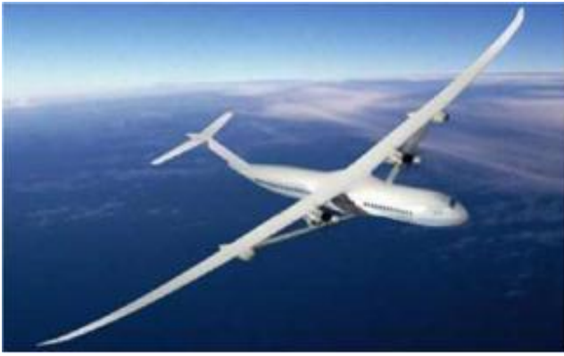
Рис. 7 Самолет с подкосным крылом конструкции «Boeing» [AI № 6 С.35]
