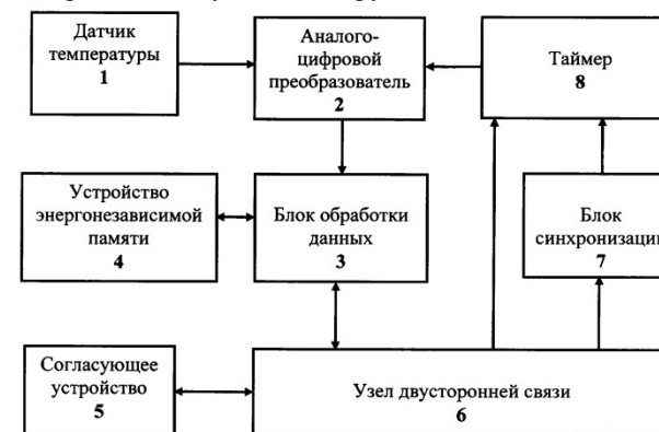
Рисунок 1.6 – Схема устройства для мониторинга температуры тела
