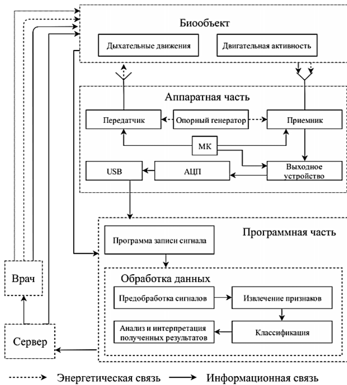
Рисунок 1.5 – Схема БТС длительного бесконтактного мониторинга структуры сна человека
