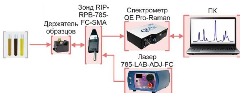
Рисунок 9 – схема экспериментальной установки для регистрации спектров КР желчи.
