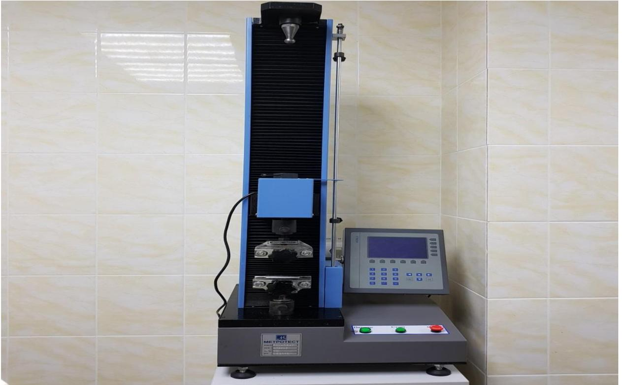
Рисунок 7 – Разрывная машина РЭМ - 0,2 - 1.
