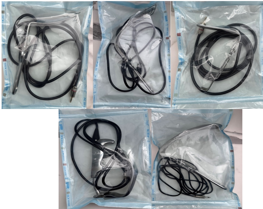
Рисунок 14 – Оригинальные светодиодные инструменты после выполненной паровой стерилизации (индикаторы изменили цвет).
