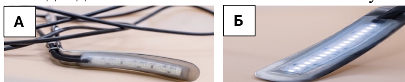
Рисунок 5 – Почечное зеркало со светодиодным осветителем на рабочей части: А – Общий вид; Б – Рабочая часть.
